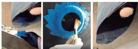
**La toallita XDClean** es segura para el transductor y ayuda a mejorar la adhesión entre el revestimiento **Foulfree™** y el transductor. Elimine cualquier residuo con un trapo limpio y seco.
